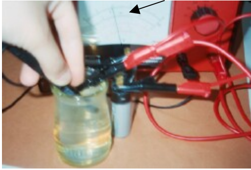
Figura 4: Medida da diferença de potencial da pilha seca novamente ligada ao circuito.
