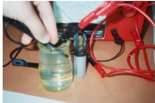
Figura 3: Medida da diferença de potencial da célula "artesanal" após 2 segundos.
