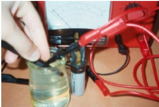
Figura 2: Medida da diferença de potencial inicial da célula "artesanal".
