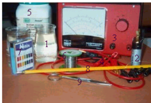
Figura 1: Material para a experiência: construção de uma célula galvânica.
