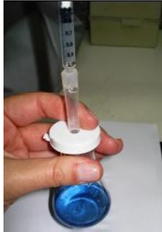
Figura 18: Ponto final da volumetria de complexação a microescala
