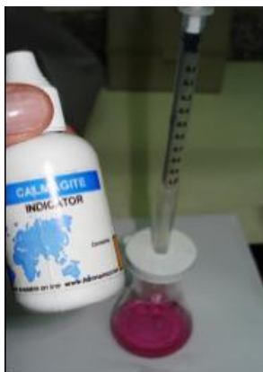
Figura 17: Volumetria de complexação a microescala
