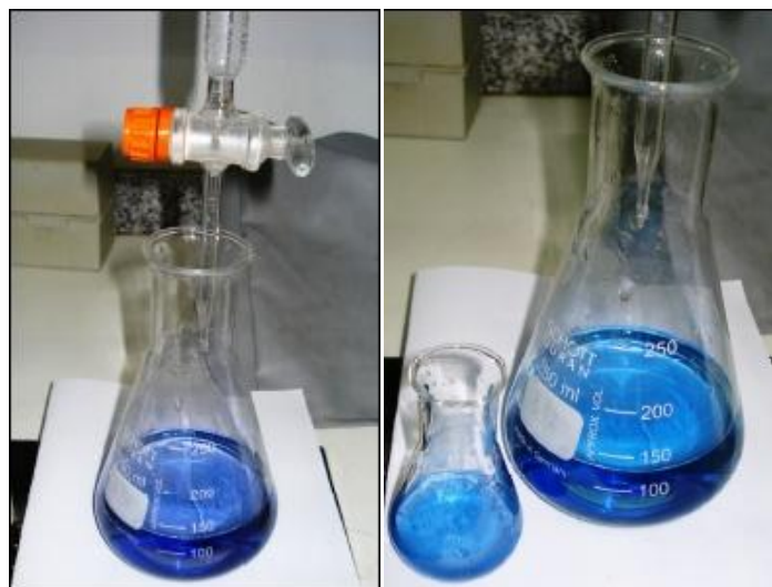
Figura 20: Ponto final de volumetria de complexação a microescala e a macroescala
