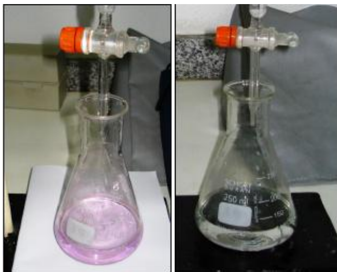
Figura 16: Volumetria ácido-base em macroescala
