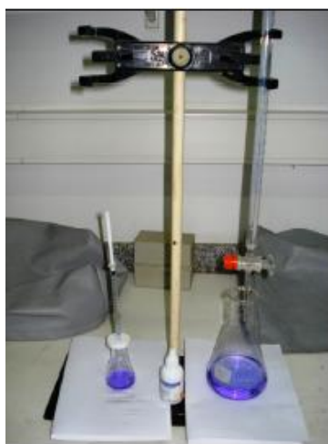
Figura 14: Volumetria ácido-base em micro e macroescala
