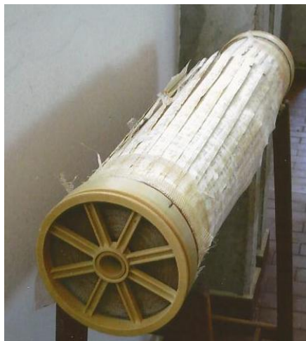
Figura 7: Membrana de osmose inversa da máquina da Dessalinizadora de Porto Santo, Madeira
