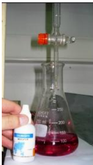
Figura 19: Ponto final de volumetria de complexação a macroescala
