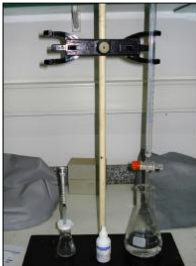
Figura 15: Ponto final da Volumetria ácido-base em micro e macroescala
